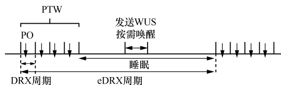
图 9 低功耗唤醒与 eDRX 结合机制
